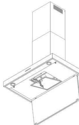
Zum Öffnen der Bodenplatte fassen Sie rechts und links in den Spalt der Randabsaugung und klappen die Bodenplatte nach unten herunter. Den Fettfilter können Sie am Griff nach unten herausziehen.
